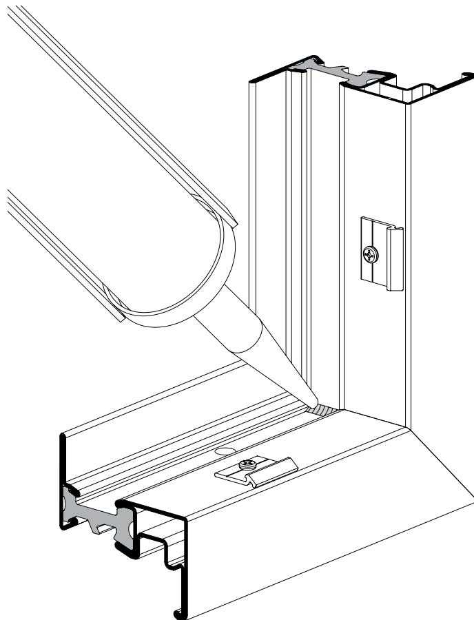
Glasfalzbereich mit Dichtmasse 450.092 abdichten
