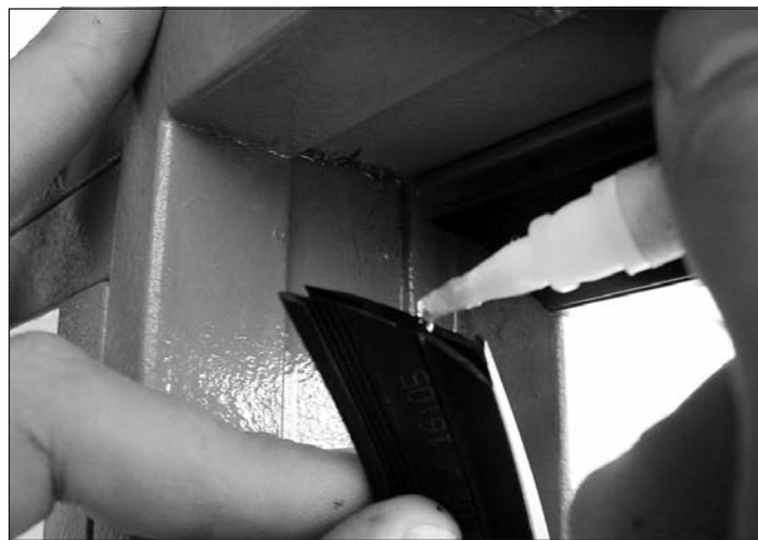
Fig. 277 Bonding the mitred corners
