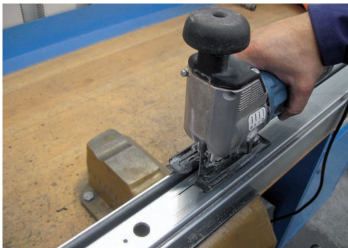
Fig. 48 Create the lock case longitudinal slot
