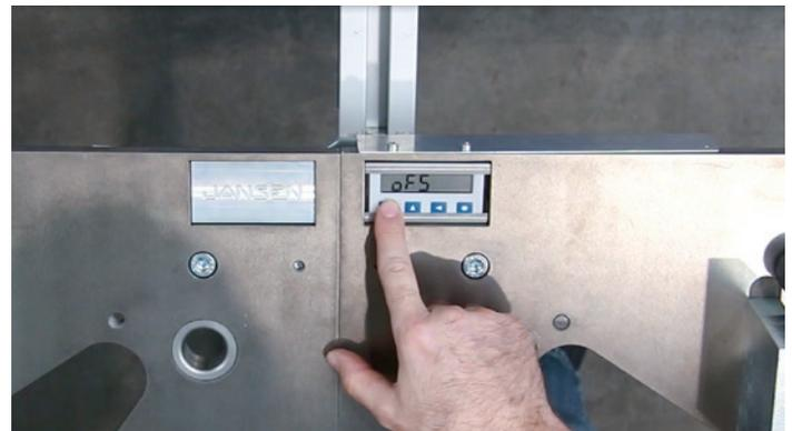
Durch kurzes Drücken der Taste «P» kann man zu dem gewünschten Parameter gelangen. In unserem Falle die Taste «P» so oft drücken, bis der Parameter «oFS» angezeigt wird. Die Anzeige blinkt immer zwischen dem Parameter (in unserem Falle oFS) und dem dazugehörigen voreingestellten Wert (z.B. 00000.0).
