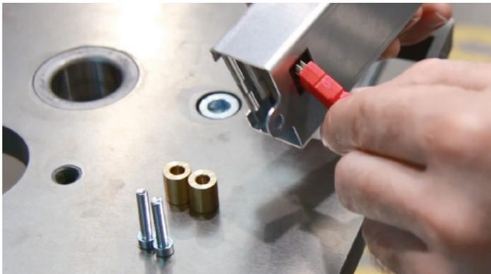
Das Kabel bzw. den Stecker des Lesekopfs an die Digitalanzeige anschliessen.
