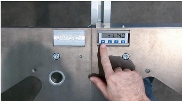
Die Taste «P» auf der digitalen Anzeige 5s gedrückt halten, um in den Programmiermodus zu gelangen. Sobald auf der Anzeige «AuFL» erscheint, kann die Taste losgelassen werden.
