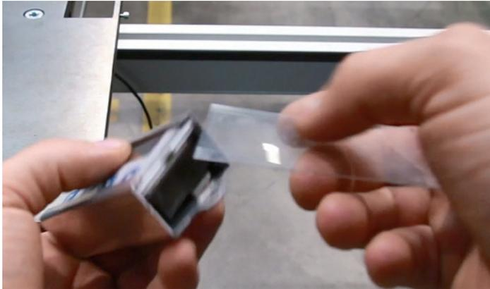
Schutzscheibe in die Halterung der Digitalanzeige schieben.
