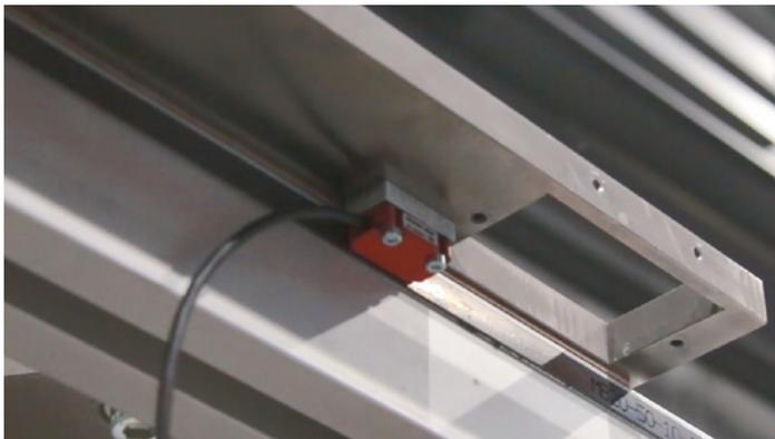
Lesekopf (rot) für Positionsanzeige gemäss Bild an den vorhandenen Gewindelöcher festschrauben. Dabei die Aluminiumplatte unter den Lesekopf legen.
