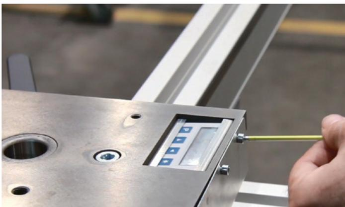
Schutzblech mit zwei Schrauben an die Aufspannecke montieren.
