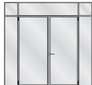
Zweiflügelige Türe mit zwei festen Seitenteilen und festen Oberlichtern Porte à deux vantaux avec deux parties latérales fixes et impostes fixes Double leaf door with two fixed side lights and fixed top lights
