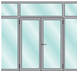
Zweiflügelige Türe mit Seitenteil und Oberlicht Porte à deux vantaux avec partie latérale et imposte Double-leafed door with side light and top light
